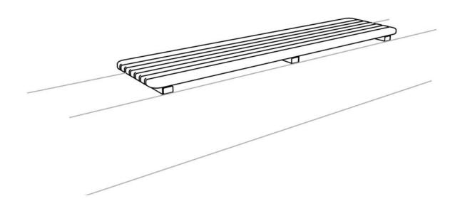
**Description**: Banquette murale. Structure en acier soudé. Les piétements sont composés de deux rails soudés à partir d'une bande pliée de 50x 8 mm et de tôle de 5 mm d'épaisseur. L'assise et le dossier sont composé de 2 lames rectangulaire de 70x32 mm et de 5 lames rectangulaire de 40×32 mm en bois tropical traité. Les planches de bois sont assemblées à la structure par des boulons en acier inoxydable.
