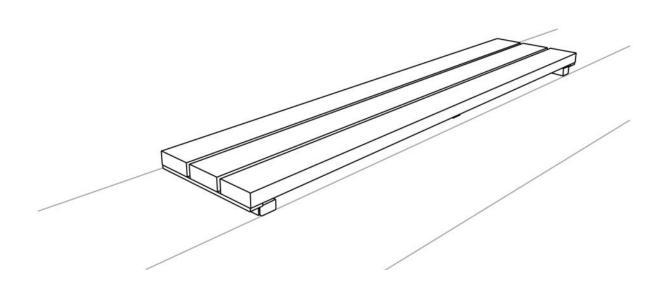
**Description** : Structure en acier galvanisé. L'assise est composée de 3 lames de bois de dimension 117x52x1800mm. La structure se fixe au mur existant avec des pièces en acier de dimension 50x25mm
