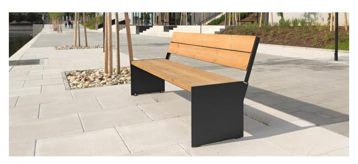
**Description**: Structure et piétement en acier galvanisé thermo laqué. Les piétements de 6 mm de large sont soudés au cadre du banc de profile 40x40 mm. Le dossier et l'assise sont composés respectivement de 2 planches rectangulaire de 140x42 mm et 3 planches rectangulaire de 140x42 mm en bois d'épicéa. Les planches de bois sont assemblées à la structure par des boulons en acier inoxydable.
