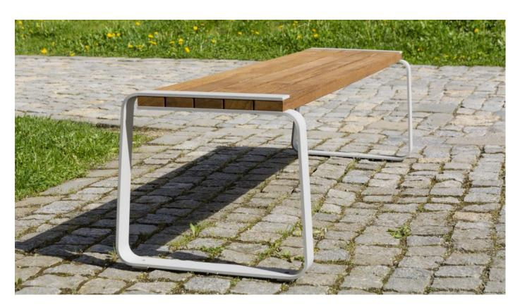
**Description**: Structure et piétement en acier galvanisé thermo laqué. Les piétements sont soudés au cadre du banc. L'assise est composée de 6 planches en bois tropical. Les planches de bois sont assemblées à la structure par des boulons en acier inoxydable.
