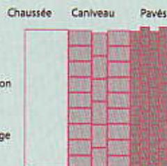
La réalisation d'un caniveau avec les éléments spéciaux fil d'eau permet de réduire très nettement le temps de pose. L'avantage de ce type d'élément est que le fond de forme est plat et que la largeur du caniveau est définie par la largeur de l'élément (existe en largeur 30 cm ou 50 cm).
