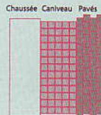
La réalisation d'un caniveau rigole avec des pavés traditionnels de hauteurs différentes, permet l'utilisation d'un fond de forme plat, ce qui facilite la mise en oeuvre du caniveau.
