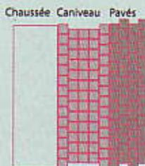
La réalisation d'un caniveau à l'aide du pavé fil d'eau, permet un gain de temps sur la mise en oeuvre du caniveau.
