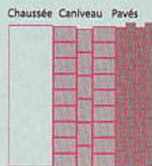
La réalisation d'un caniveau en pied de bordure à l'aide du pavé fil d'eau, permet l'utilisation d'un fond de forme unique pour les 2 éléments.
